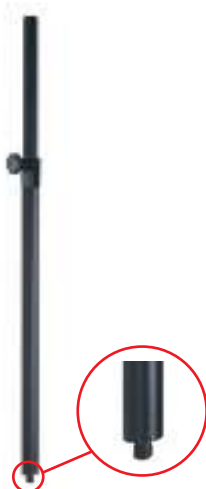
01282 TUBE D'ENCEINTE Tube Alu télescopique noir - 35 mm / M20 - Longueur 905 à 1615 mm - Haut : diam 35 mm mâle - Bas : Filetage M20 mâle - Charge max : 30 kg / Poids : 1 kg
